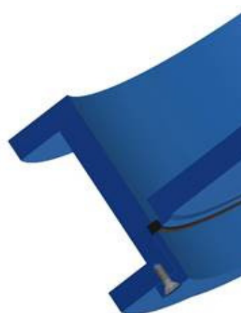
Detalhe da vedação no corpo
