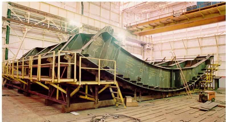
L'étanchéité du tablier est obtenue par l'intermédiaire de joints en caoutchouc types note de musique ou bien profilés et plats, fixés à la structure métallique de la vanne et appuyés sur les pièces fixes du pertuis.
